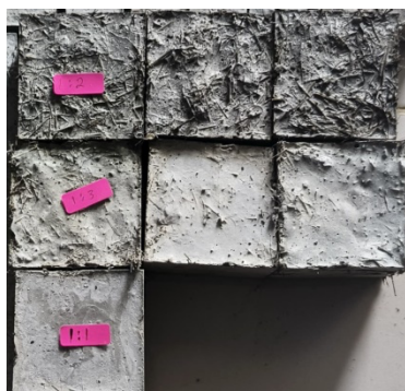
Gambar 1. Sampel komposit geopolimer dengan tiga variasi rasio serat ijuk
